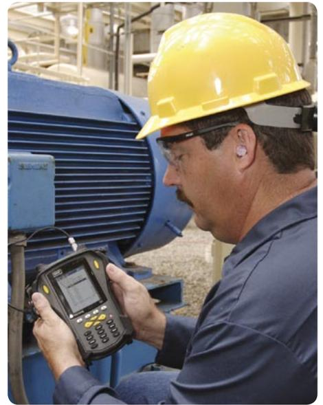
*Rilevamento dei valori di vibrazione, utilizzando gli strumenti di acquisizione dati della SKF della serie Microlog*
